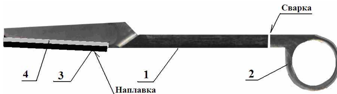
Рис. 2. Схема сварного медицинского инструмента:
