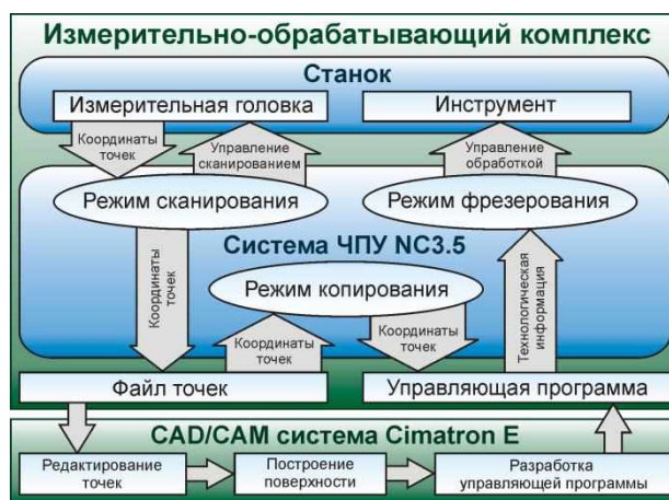
Рис. 3. Схема работы математического обеспечения СПУ NC 3.5
