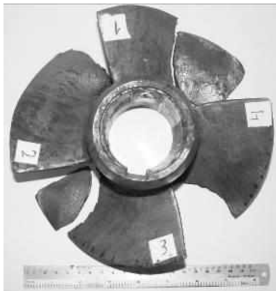
Рис. 8. Разрушение лопаток колеса
