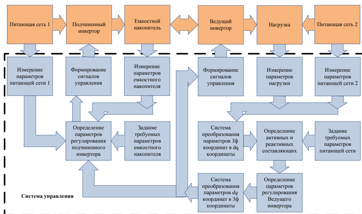
Рис. 1. Структурная схема силовой части UPFC и её системы управления
