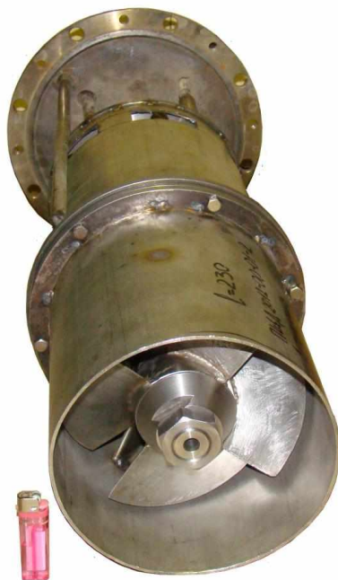
Рис. 2 Фото экспериментального участка (выемной части) стенда ФТ-4А
