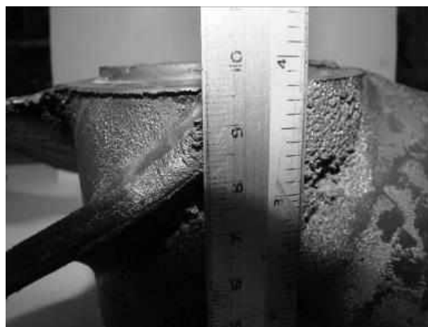
Рис. 9. Разрушение ступицы колеса
