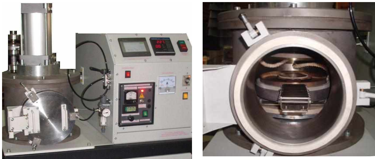
Рис. 3. Опытно-промышленная установка анодной сварки
