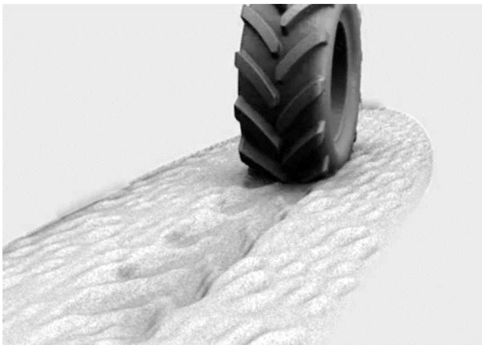
Рис. 4. Взаимодействие шины с деформируемым грунтом [11]
