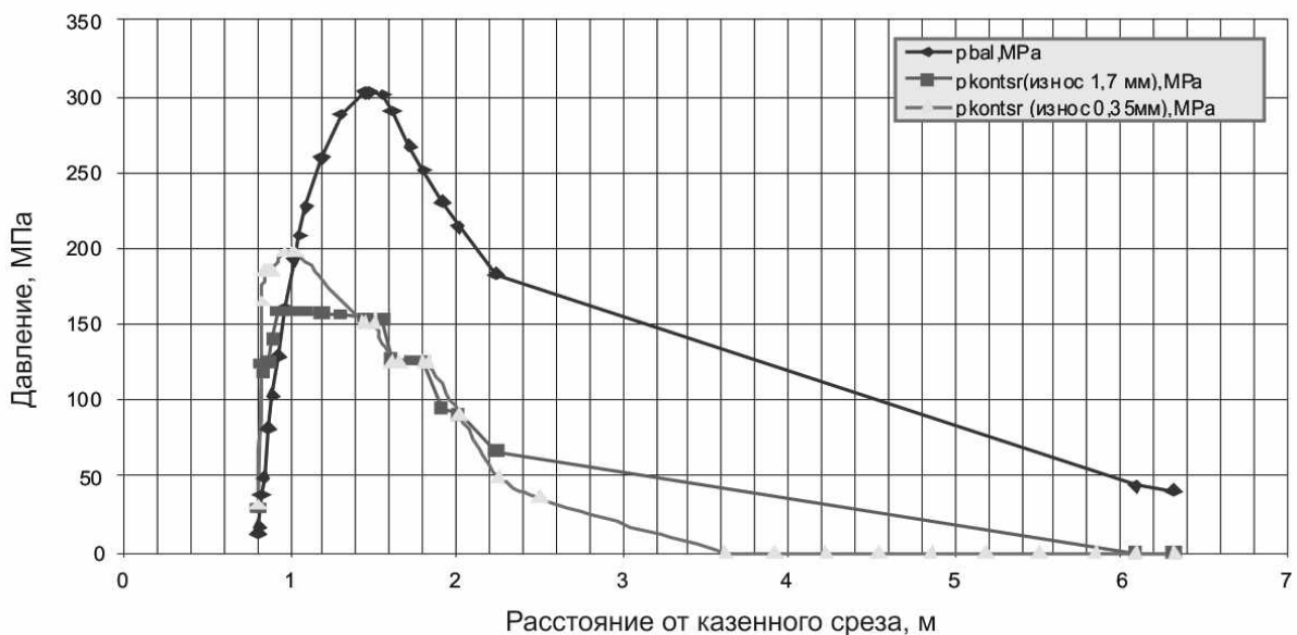
Рис. 3. Изменение контактного давления ведущего пояска в зависимости от износа трубы (изделие 2А46М, осколочно-фугасный снаряд)
