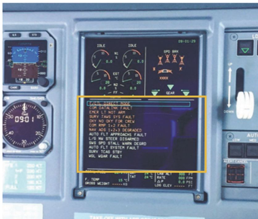
Рисунок 4. Сигнальная зона текстовых сообщений на МФИ пассажирского авиалайнера
