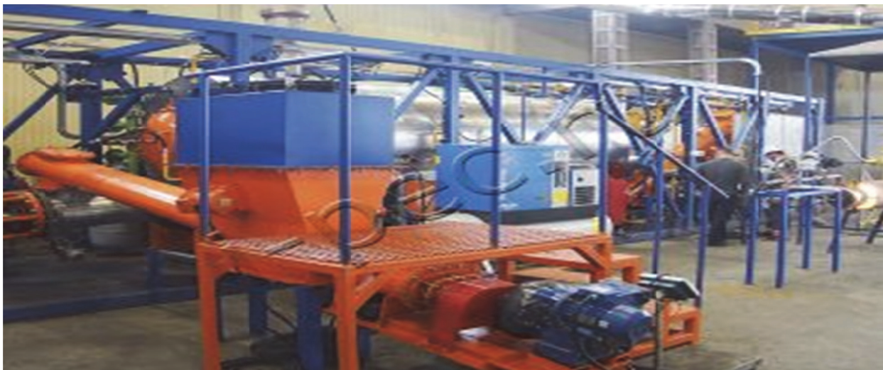
Рисунок 2 – Многофункциональный сортировочный комплекс переработки ОЭЭО Fig. 2 – Multifunctional sorting processing complex of E-waste
