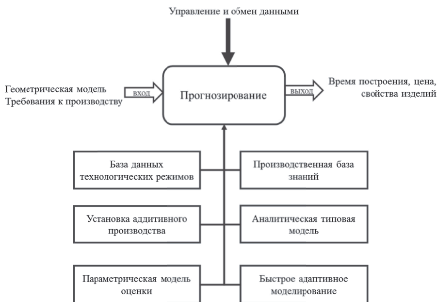
Рис. 7. Функциональный блок «Прогнозирование»
