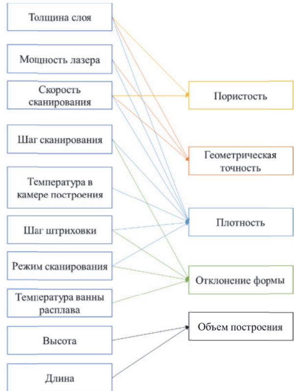
Рис. 2. Взаимосвязи между технологическими параметрами и предсказываемыми свойствами изделия
