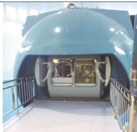
Рис. 7. Общий вид двухместной кабины со стороны входа. Люки открыты. В левом отсеке предполагается размещение испытателя (космонавта), в правом - врача УЗДГ
