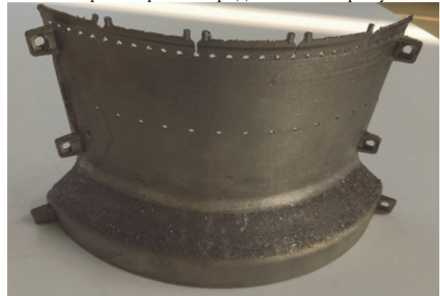
Рис. 2. Выращенный сегмент камеры сгорания
