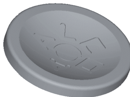
Рис. 8. Внешний вид конечно-элементной модели матрицы
