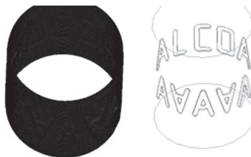
Рис. 18. Внешний вид фрагмента банки с рельефом на боковой поверхности, получаемым в результате магнитно-импульсной формовки
