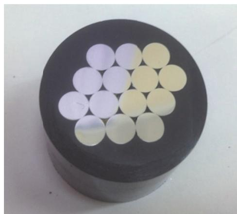
**Рис. 2.** Образец для рентгеноструктурного анализа
