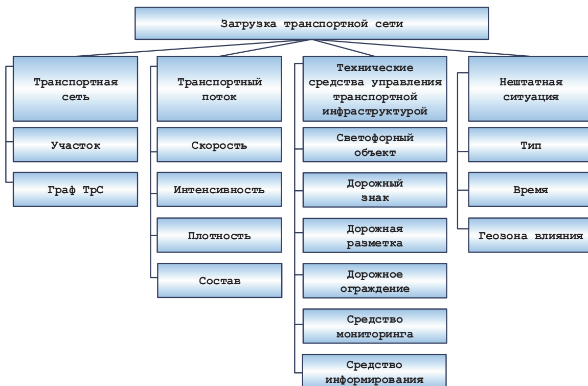
Рис. 1. Декомпозиция предметной области «Загрузка транспортной сети»
