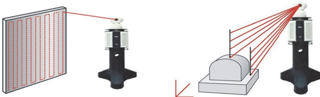
**Рис. 1.** Процесс сканирования лазерной координатно-измерительной системой на базе лазерного сканера
