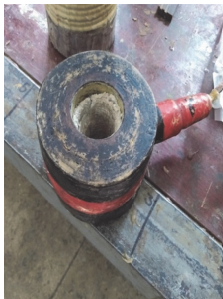
Рис. 3. Индуктор для принудительно плакирования с асбестовой втулкой внутри
