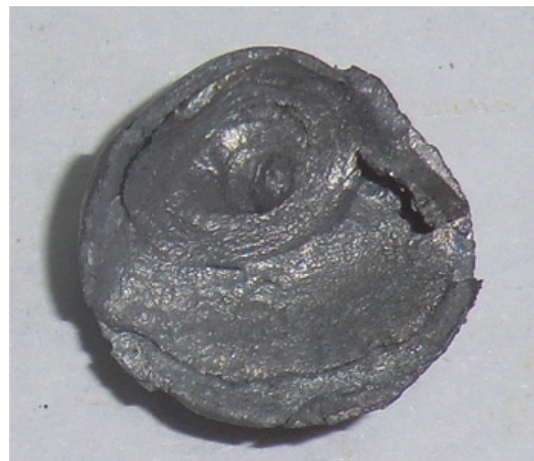
Рис. 4. Вид вырубki винтовочной пулей 7,62\54 со свинцовым сердечником из пластины стали Ст.3 со свинцом внутри (слева)
