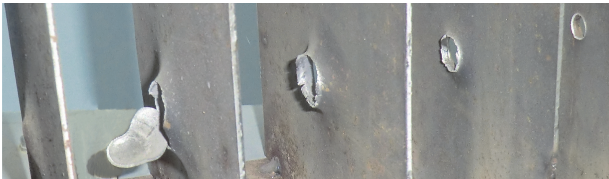
Рис. 6. Процесс прострела разнесённой многослойной преграды автоматной пулей 7.62 мм: справа налево - 3 пластины со сквозным пробитием, образование чашечки отгиба, непробитие
