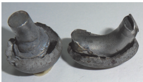
Рис. 3. Вырубки при лобовом (слева) и при боковом (справа) соударении пули с преградой: сердечники автоматной пули (слева) и винтовочной (справа) вложены в свои же вырубки
