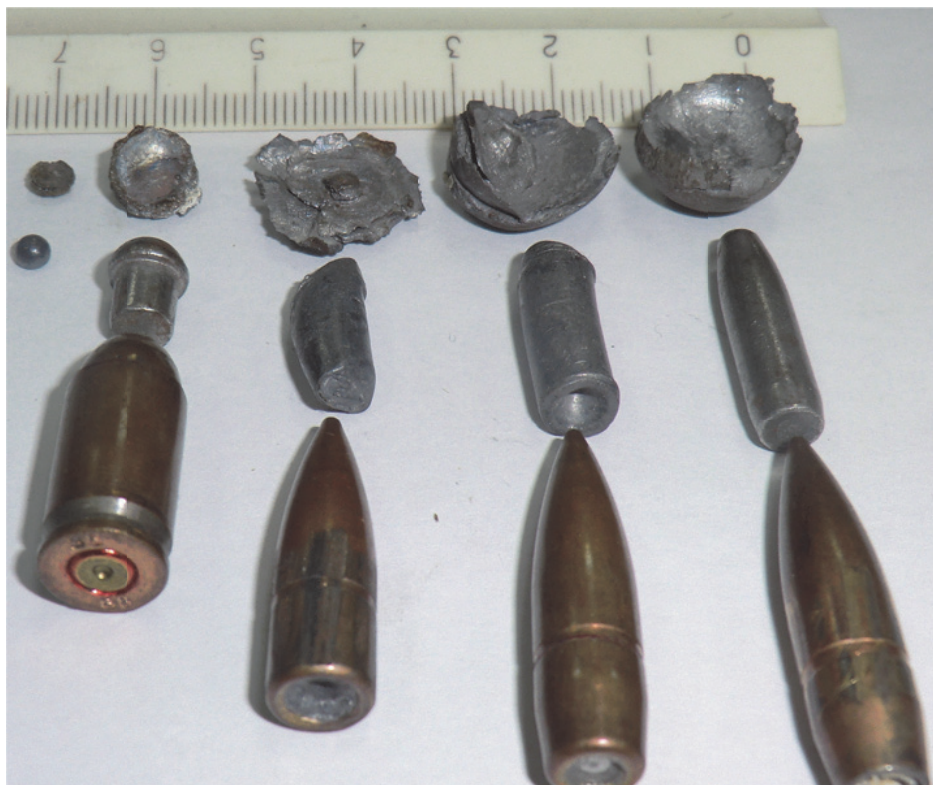
Рис. 5. Общий ряд типичного выбивания металла из преграды в виде пробки в зависимости от типа пули
