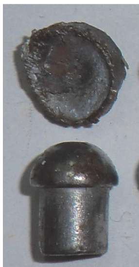
Рис. 2. Образование чашечки после выстрела пуль пистолета Макарова
