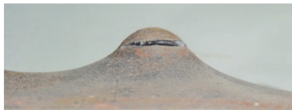
Рис. 1. Процесс начала образования вырубной чашечки
