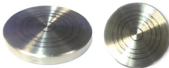
Рис. 2. Образец после испытаний и с использованием СОЖ. Общий вид (слева) и вид сверху (справа)
