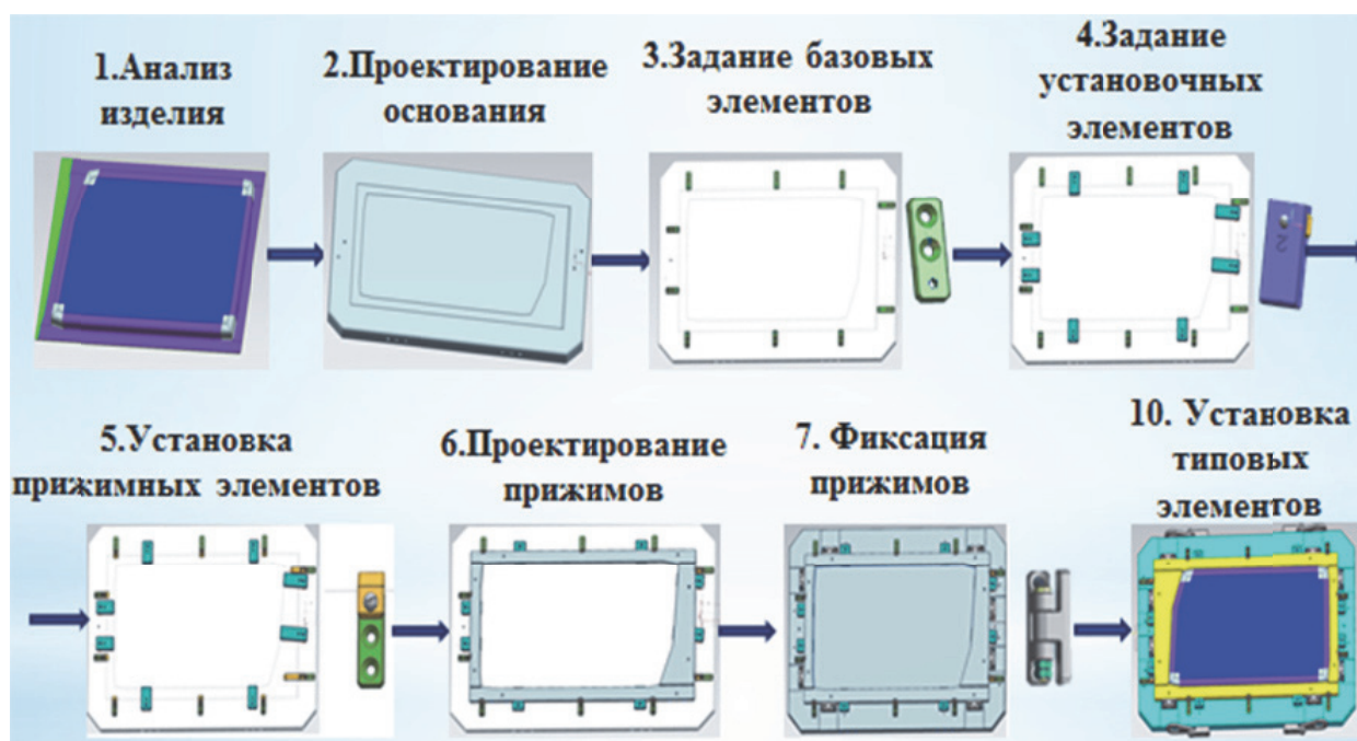
Рис. 2. Процесс проектирования сборочно-клеечной оснастки
