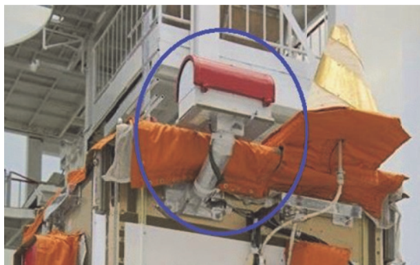
Рис. 2. Прибор ориентации по Земле
