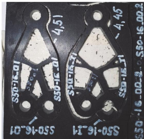
Рис. 12. Образцы после испытаний. Разрушение – в проушинах основания
