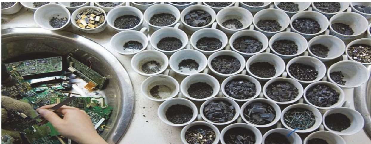
Рисунок 1 – Раздельный сбор полезных компонентов ОЭЭО Fig. 1 - Separate collection of useful components of the E-waste
