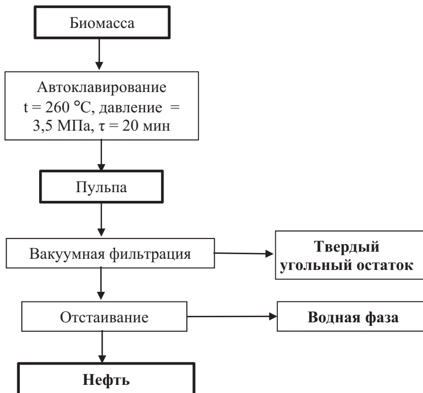
Рисунок 1. – Порядок проведения процесса гидротермального ожигения КДО
