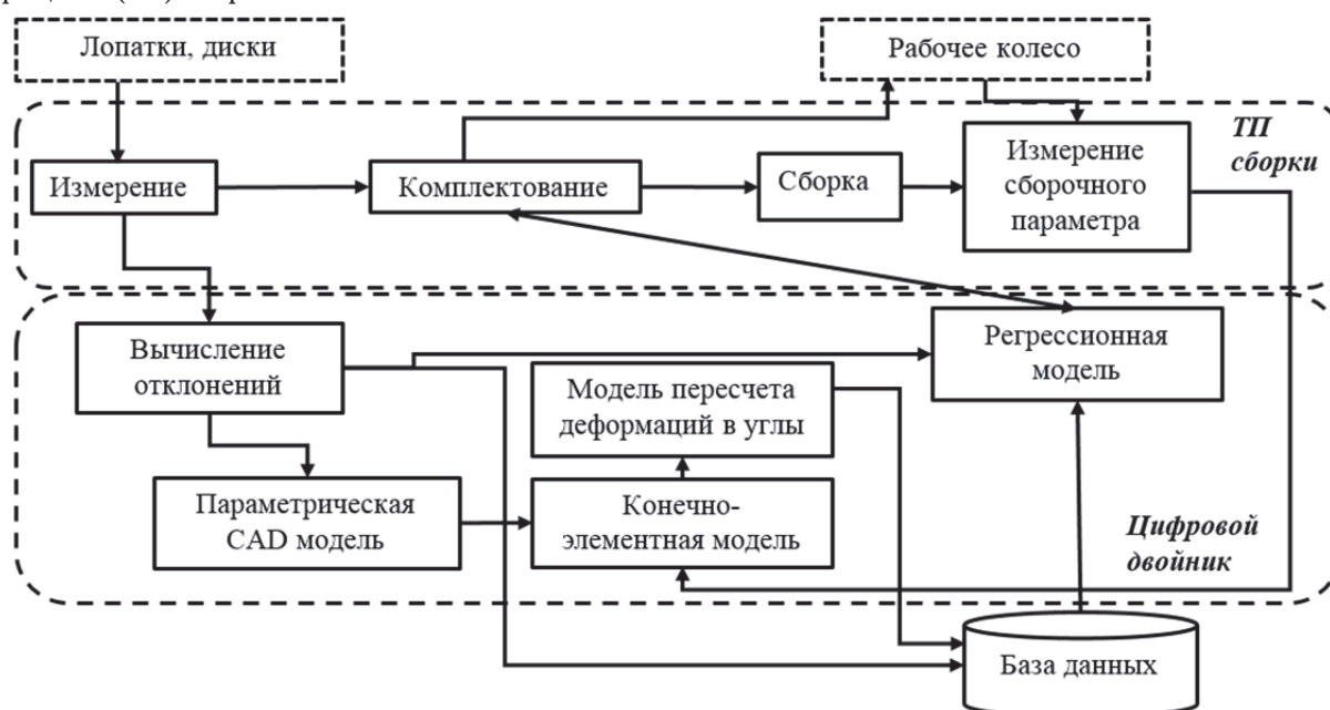
Рис. 4. Архитектура цифрового двойника процесса сборки рабочих колёс
