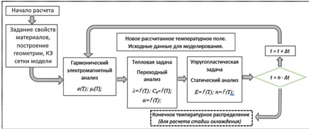
Рис. 1. Алгоритм моделирования стадии индукционного нагрева
