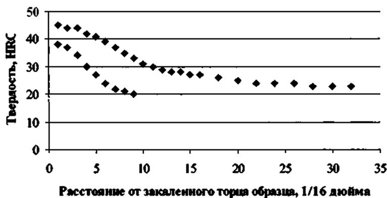
Рис. 1. Полоса прокаливаемости стали 4815H
