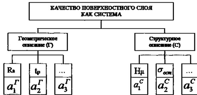
Р и с. 2. Система качества поверхностного слоя с позиции многокритериальной оптимизации
