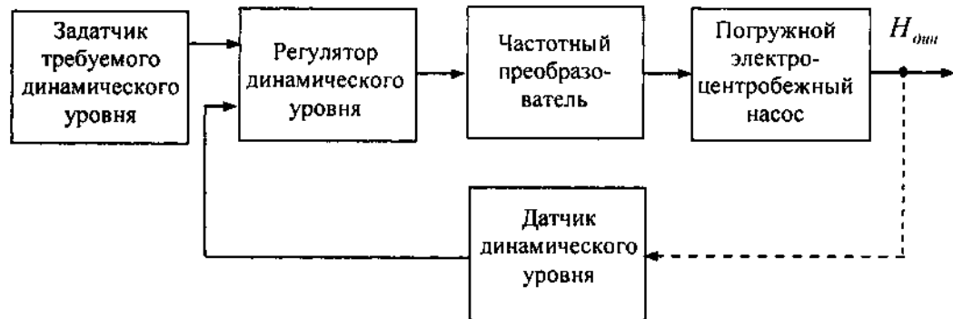
Р и с. 1. Функциональная схема системы управления погружным электроцентробежным насосом
