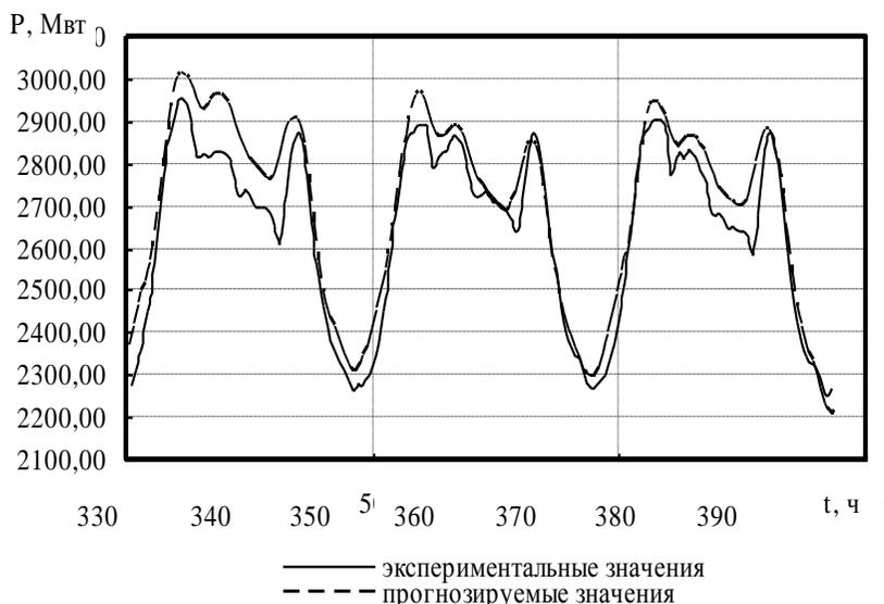
Рис. 3. Графики экспериментальной и расчетной функций на прогнозируемом промежутке времени
