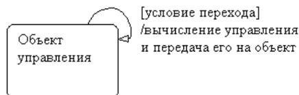
Р и с. 1. Представление в виде гибридного автомата системы автоматического управления с императивной моделью регулятора
