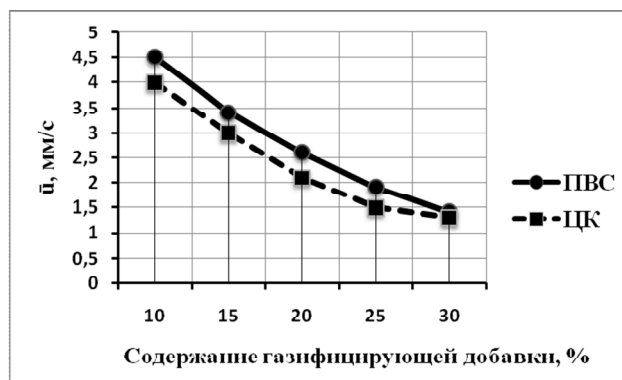
Р и с . 5. График зависимости скорости горения от содержания ПВС и ЦК в тройной смеси НК-БК-ГД
