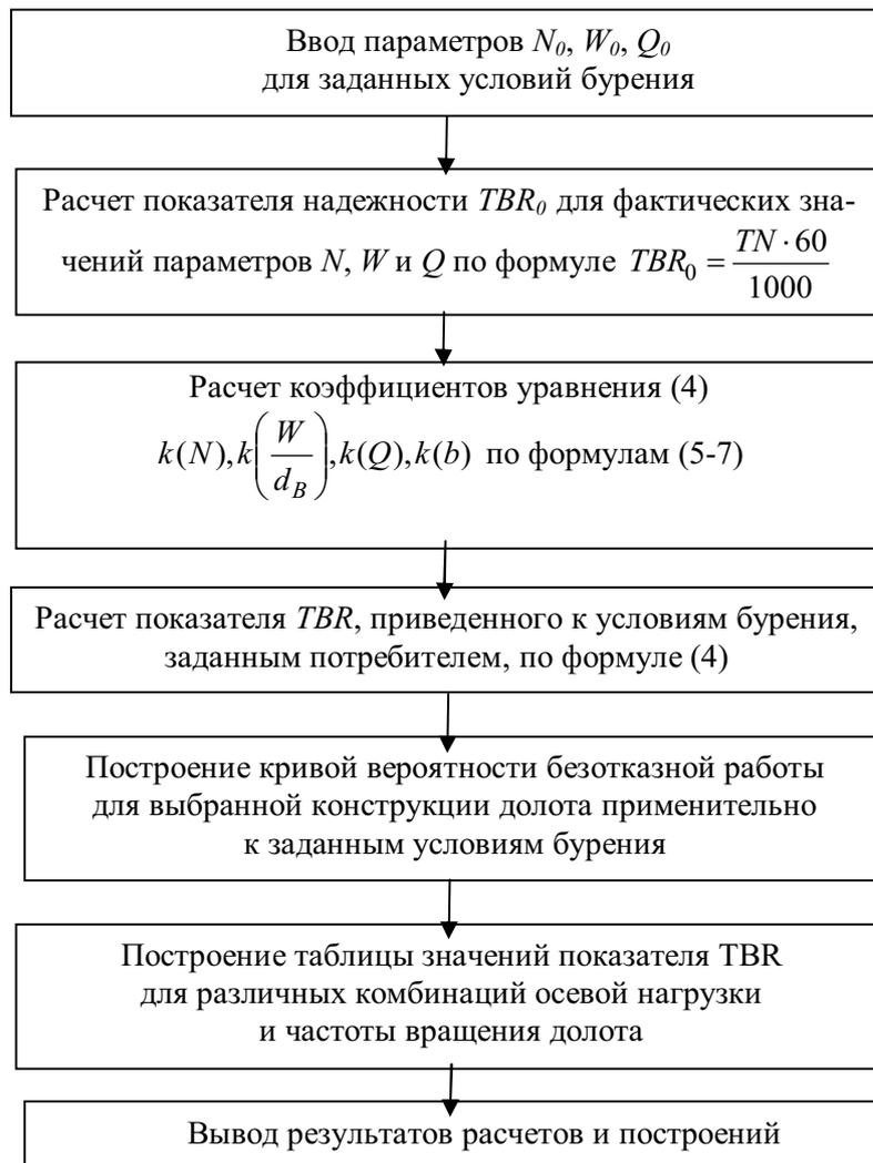
Р и с . 1. Блок-схема анализа общего ресурса опоры долота по предлагаемой методике
