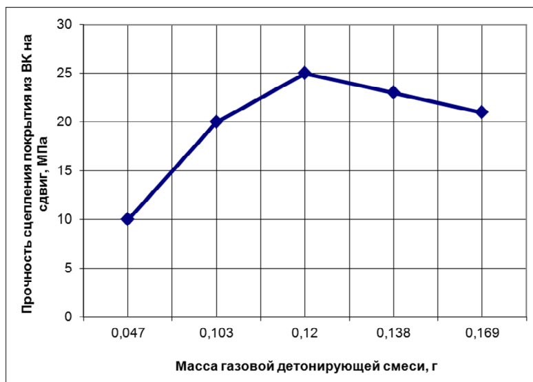
Рис. 3. Зависимость прочности сцепления покрытия с подложкой от массы детонирующей смеси
