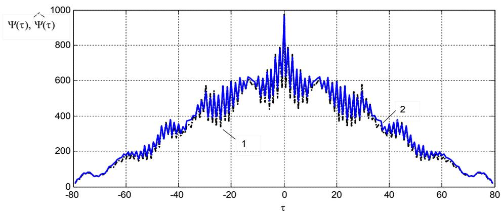
Рис. 2. Автокорреляционные функции  $\Psi(\tau)$  наблюдаемого временного ряда (1) и  $\hat{\Psi}(\tau)$  его аппроксимации (2)
