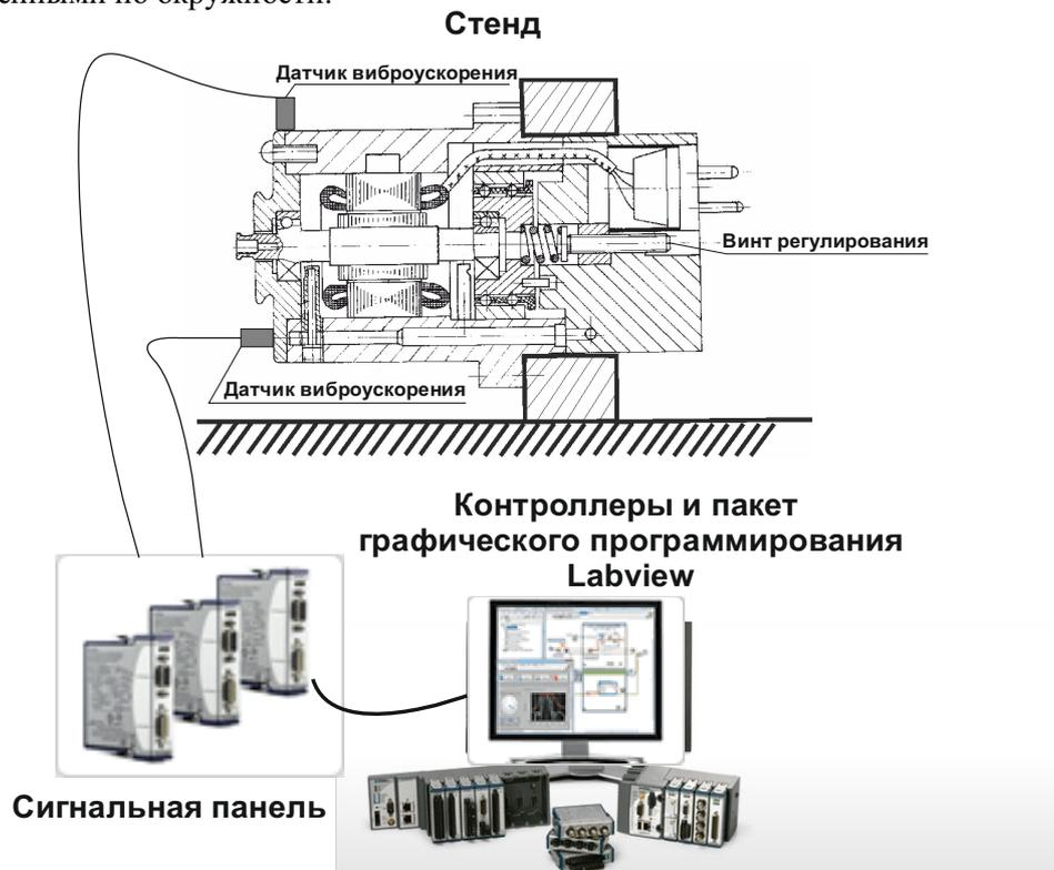
Рис. 1. Экспериментальная установка и схема сбора информации
