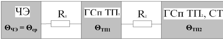
Рис. 3. Модель передачи тепла в ТВ с двумя встроенными ТП
