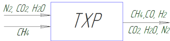
Рис. 1. Схема преобразования потоков в термохимическом реакторе
