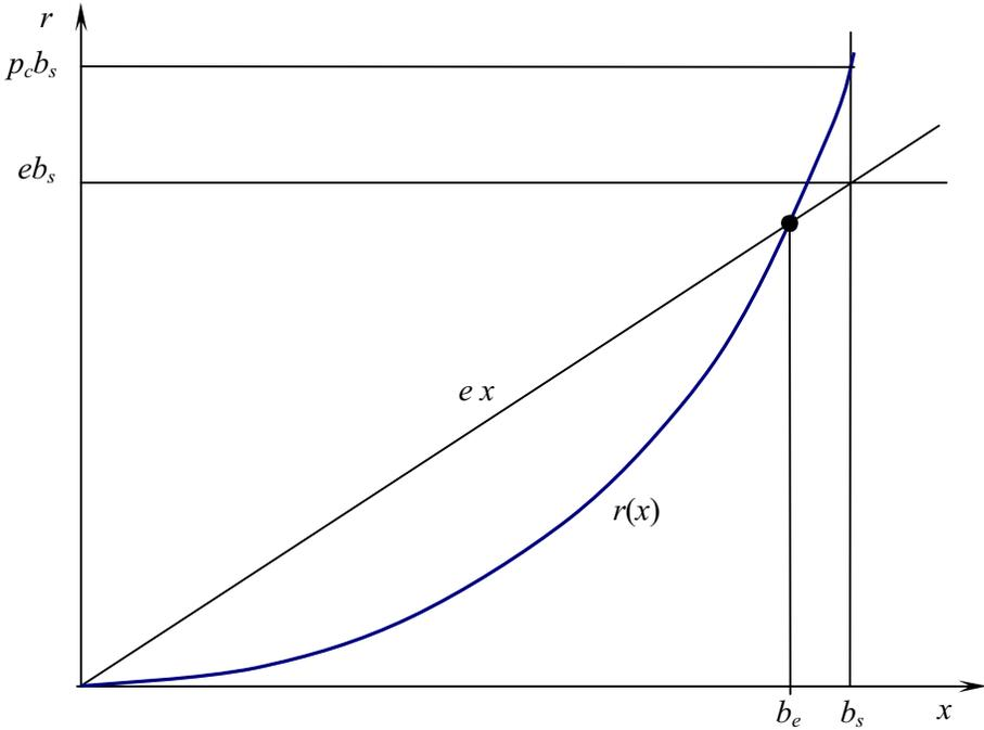
Рис. 1. Непрерывное распределение ресурса  $r(x)$  при линейно возрастающей функции  $p(x)$
