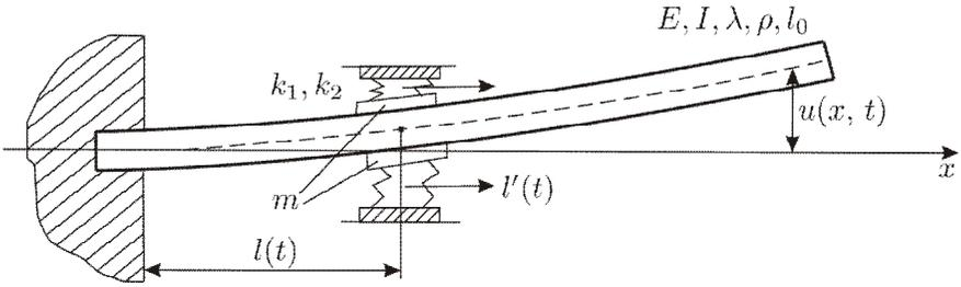
Рис. 1. Кинематическая схема балки
