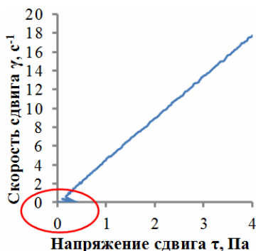
Рис. 1. Зависимость скорости сдвига от напряжения сдвига образца нефти Юганского месторождения (пласт Д 3fn ) при 46 °С
