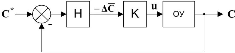
Рис. 1. Система автоматического управления по переменным состояния
