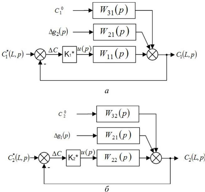
Рис. 2. Система автоматического регулирования концентрации а -  $C_1(L, t)$  б -  $C_2(L, t)$
