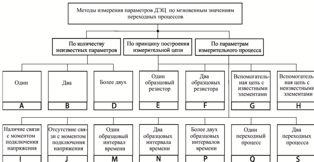
Рис. 1. Классификация методов измерения параметров ДЭЦ по мгновенным значениям переходных процессов
