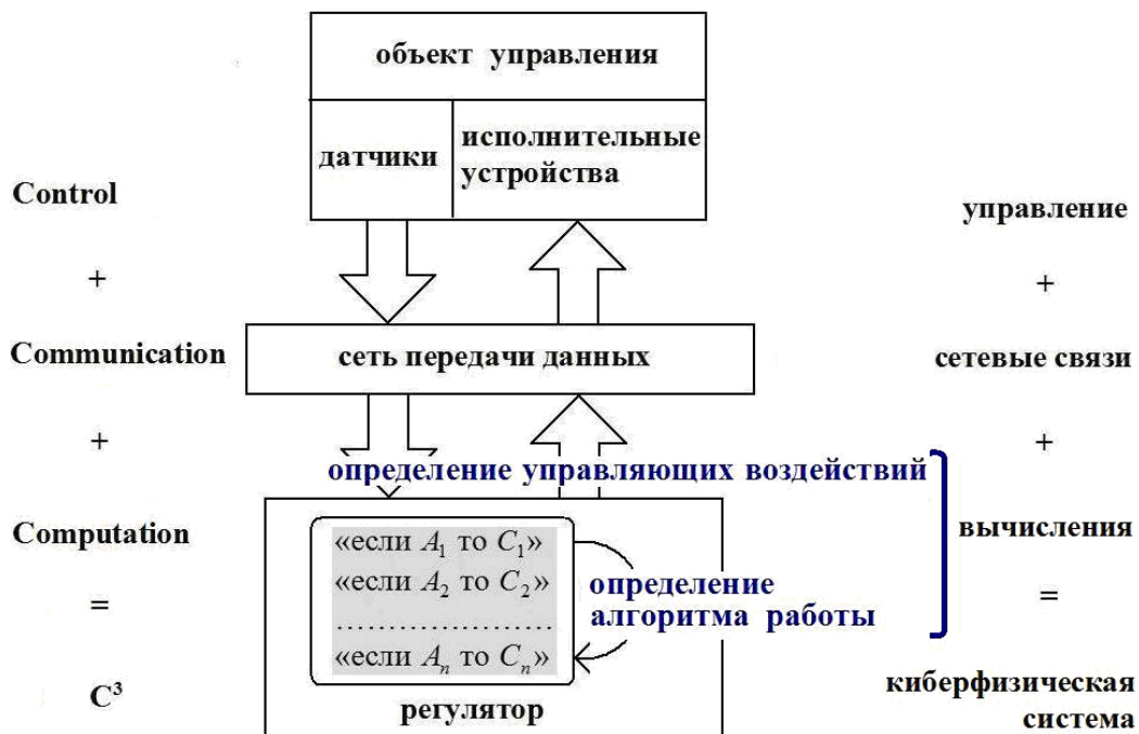
Рис. 1. Блок-схема системы управления с продукционной моделью регулятора
