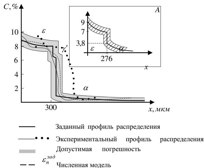
Распределение азота для технического железа, А – требуемое распределение для стали 38Х2МЮА
