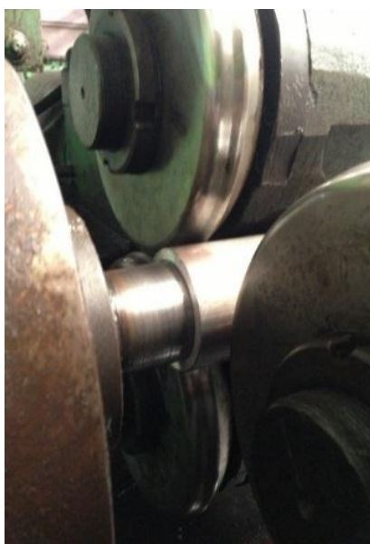
Рис. 1. Обкатывание трубной заготовки роликами
