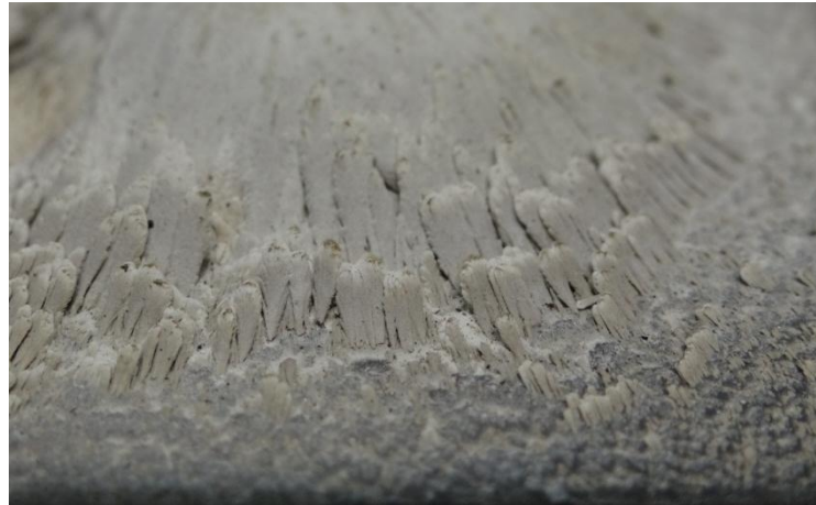
Рис. 2. Монокристаллы корунда в виде зубьев, сформированные при напылении керамического покрытия. Видна ориентация кристаллов в направлении потока напыляемых частиц
