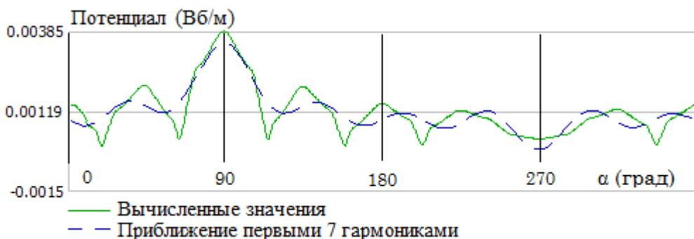
Рис. 2. Кривая магнитного потенциала на поверхности ротора
