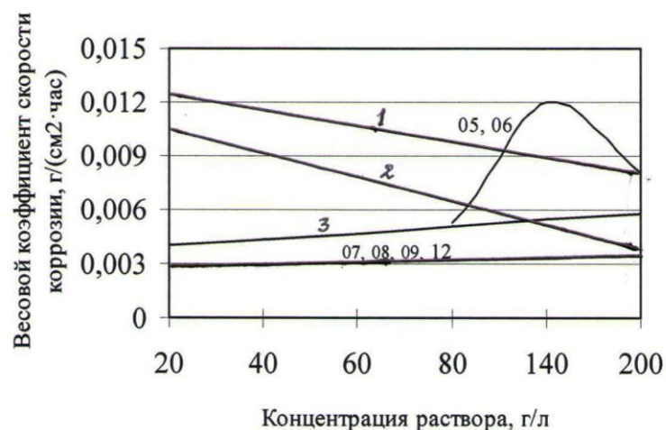
Рис. 3*. Зависимость весового коэффициента скорости саморастворения образцов от минерализации раствора:
