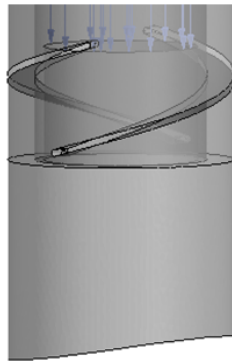
Рис. 8. Конструкция модельного гидроциклона ( a ); зависимость его коэффициента сепарации от подачи ( б )
