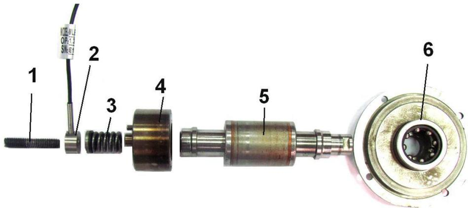
Рис. 2. Схема последовательного расположения элементов измененной конструкции мотор-шпинделя:
