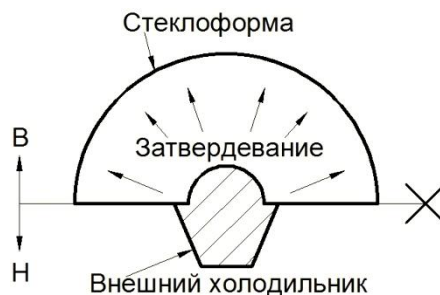
Рис. 1. Технология изготовления литых заготовок стеклоформ
