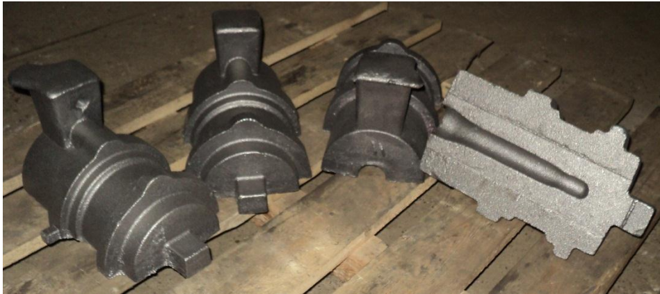
Рис. 2. Литые заготовки стеклоформ с прибылями
