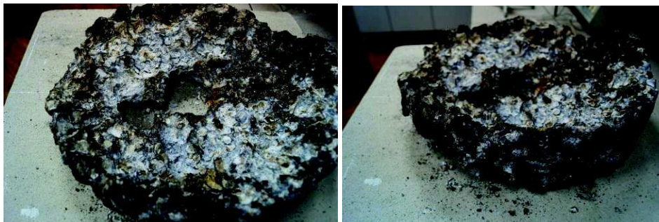
Рис. 2. Общий вид протектора после пяти лет эксплуатации
