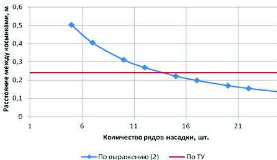
Рис. 5. Зависимость расстояния между косынками от количества рядов насадки АВР 60×60 с толщиной элементов 0,8 мм
