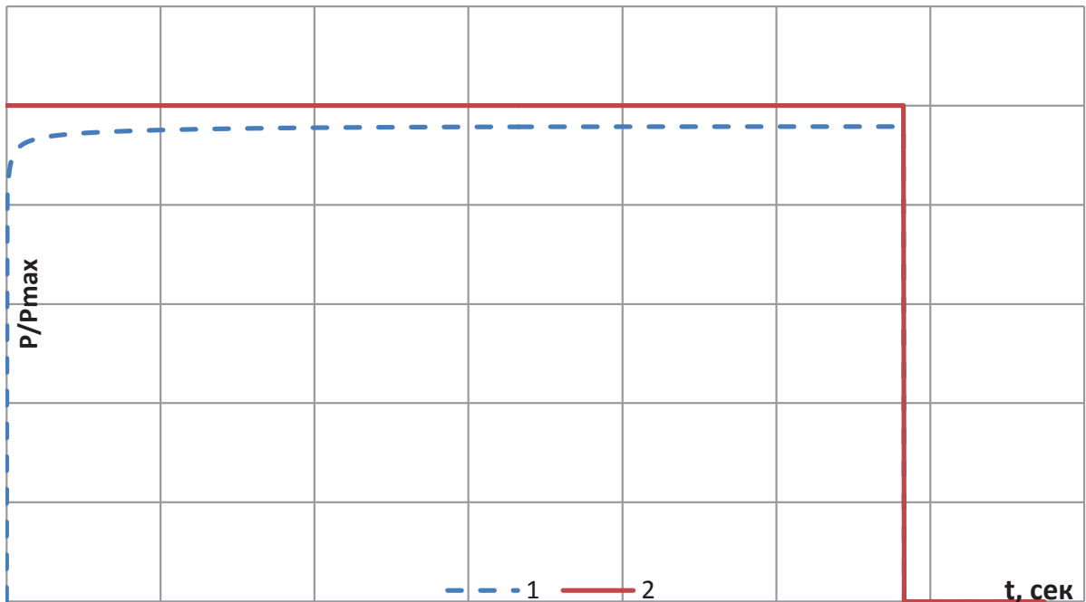
Рис. 5. График изменения управляющего воздействия в синтезированной системе (1) и системе оптимального программного управления (2) при изменении температуры заготовки на 20\text{ }^{\circ}\text{C}
