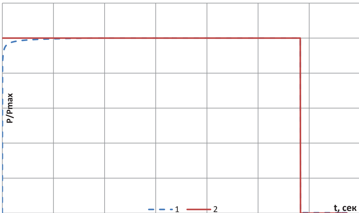
Рис. 3. График изменения управляющего воздействия в синтезированной системе (1) и системе оптимального программного управления (2)
