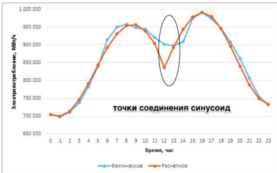
Рис. 2. Фактический и аппроксимированный графики электропотребления ООО «Омская энергосбытовая компания» за 16.09.2015
