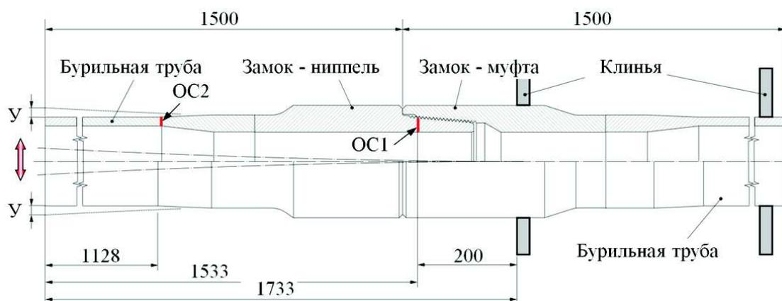
Рис. 4. Схема нагружения испытуемого образца
