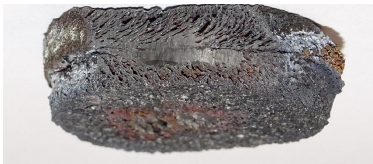
Рис. 5. Общий вид слоевого образца, синтезированного из двух шихтовых брикетов по 10 г и брикета никеля 8 г между ними, диаметр 23 мм
